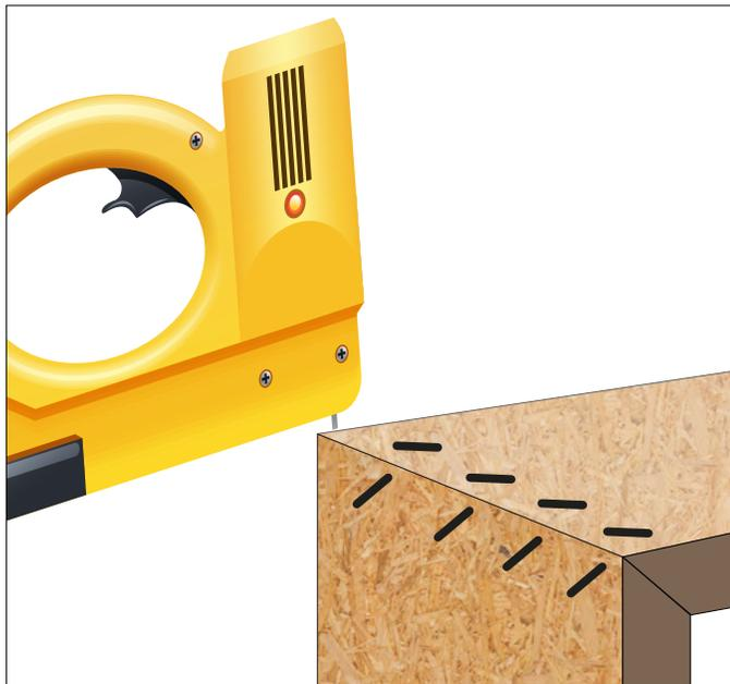
**4.4. Usando Cavilhas:** De preferência, use cavilhas estriadas para uma boa fixação de cola. O diâmetro de furo para alojamento deve ser ligeiramente maior, permitindo a colocação de forma manual. A profundidade de perfuração deve ser de 1 a 2 mm maior que o comprimento da cavilha. Observe a distância mínima de 25mm do canto do painel.
