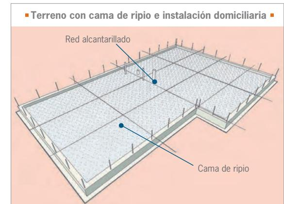
Se debe compactar adecuadamente esta cama de ripio, para luego instalar una cama de arena de 4 a 5 cm, la que tiene como función lograr una superficie lisa, horizontal, exenta de piedras anguladas que ocasionen rotura en el polietileno de 20 micras de espesor, el que se instalará como **barrera de humedad** sobre la arena.
