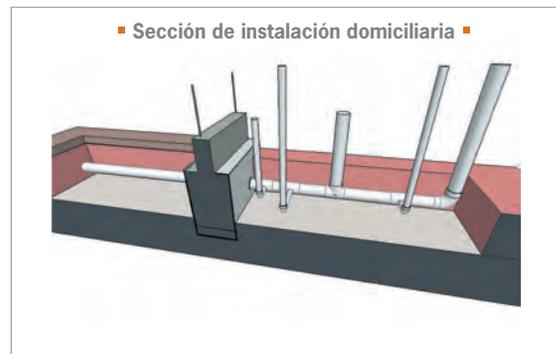
Sobre el estabilizado de relleno, se instala una cama de ripio o grava, de 8 a 10 cm de espesor, que tiene como función impedir que el agua ascienda por **capilaridad** del suelo hacia el radier.
