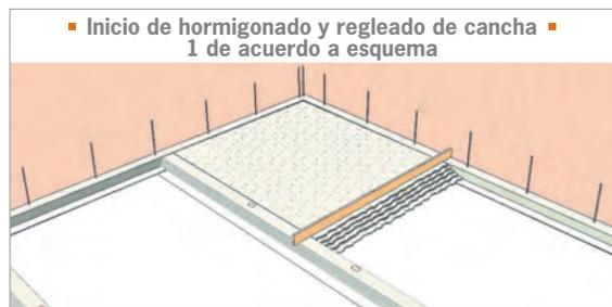
Una vez regleado el hormigón se debe compactar o vibrar con el fin de eliminar las burbujas de aire que quedan en él, lo que asegurará un hormigón homogéneo y libre de nidos de ripio.
