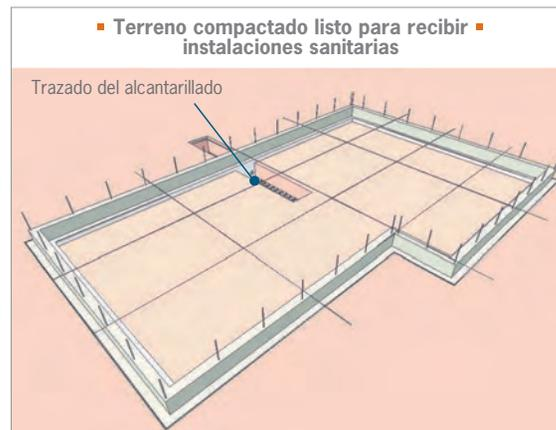
A continuación se procede al trazado de la planta de evacuación del alcantarillado, la que deberá ser ejecutada por un instalador autorizado.
